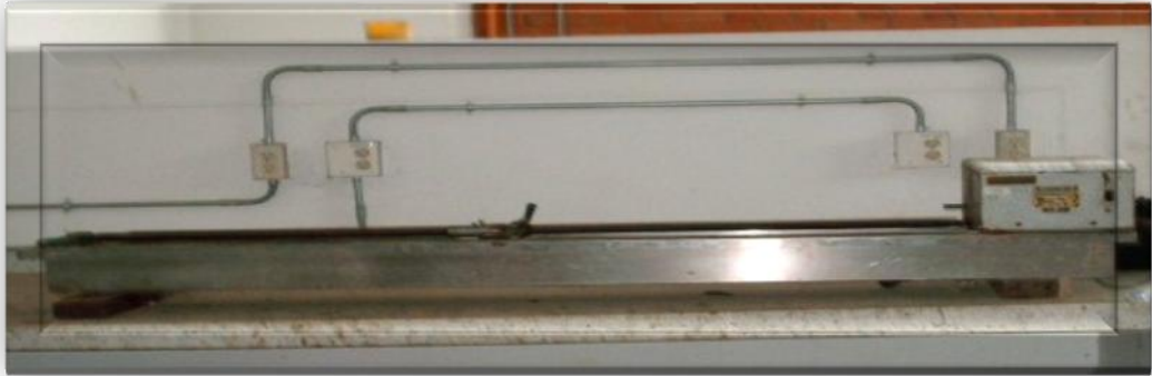
Foto 10. Placas de bronce con asfalto, sumergida en un baño de agua destilada a 25°C
