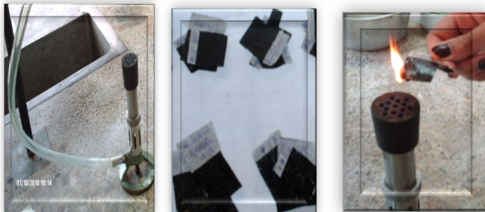
Foto 44. Muestras 1, 2, 3, 4, 5, 6. Resistencia a la llama
