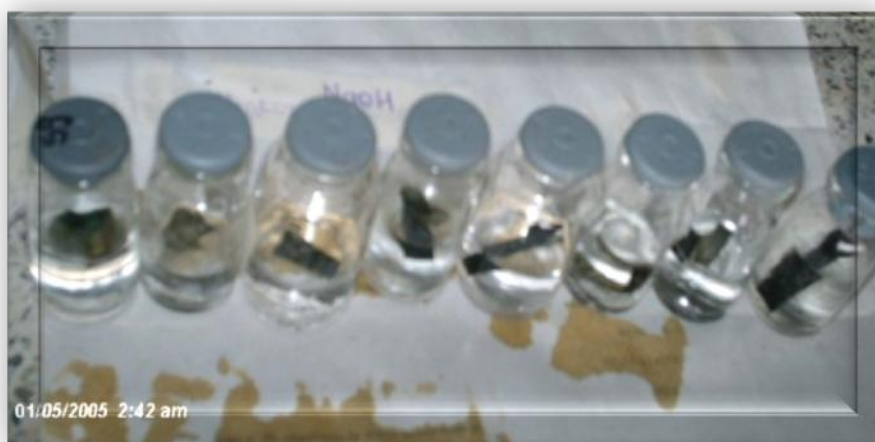
Foto 24. Resistencia Hidróxido de Sodio 10% p/p a (25°C y 50 °C)
