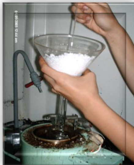
Foto 4. Incorporación del EPS- post consumo al asfalto oxidado
