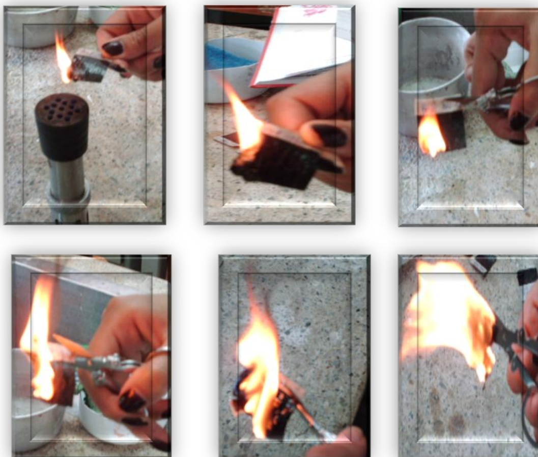
Foto 44. Muestras 1, 2, 3, 4, 5, 6. Resistencia a la llama
