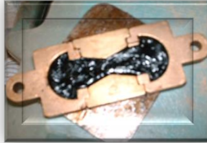
Foto 8. Esquema ensayo de Ductilidad.
