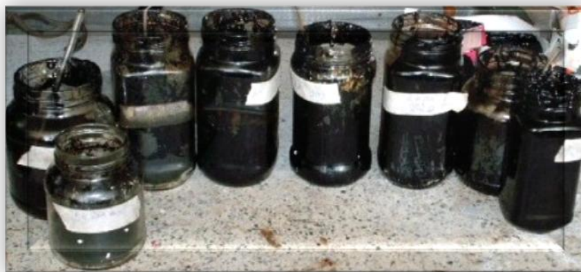
Foto 5. Muestras obtenidas de asfalto oxidado modificado con EPS- post consumo
