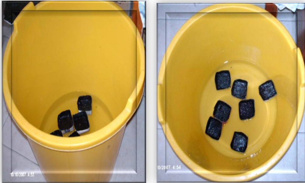
Foto 42. Ensayo de impermeabilización Desprendimiento del papel
