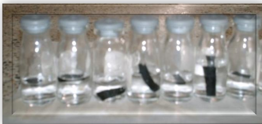
Foto 21. Resistencia al Acido Acético 10% p/p a (25°C y 50 °C)
