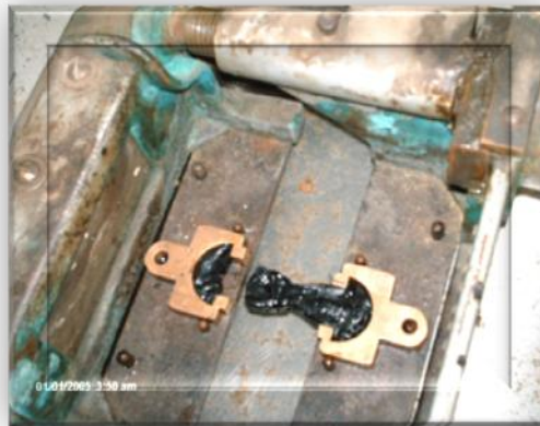
Foto 12. Estiramiento hasta su rotura
