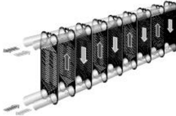
Figura A. 2. Configuración operacional de los intercambiadores de placas de C.E.S
