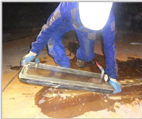
Fotografía 31: Ensayo de cámara de vacío.
