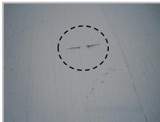
Fotografías 17 y 18: Rebabas internas y externas en el cuerpo.
