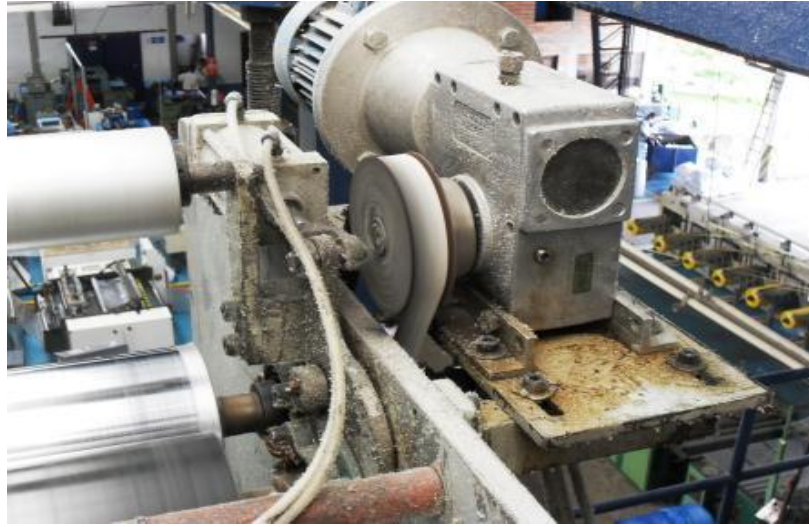
Figura 37. Motor y caja reductora del nip roll
