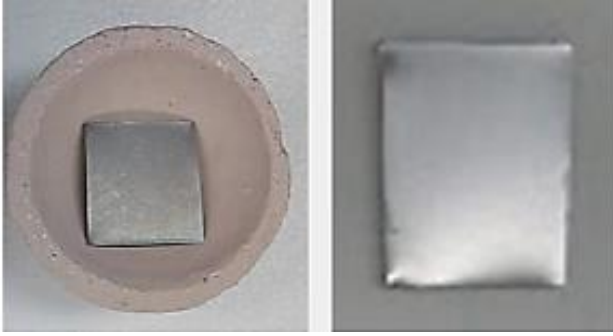
Figura 24: Imagen del electrodo de trabajo/ Contraelectrodo antes de iniciar el proceso de macroelectrólisis
