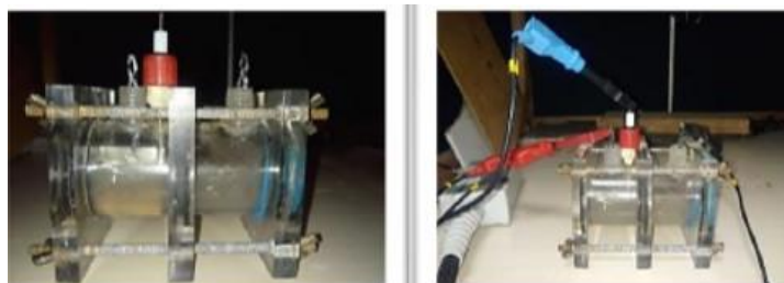
Figura 12: Celda de macroelectrólisis
