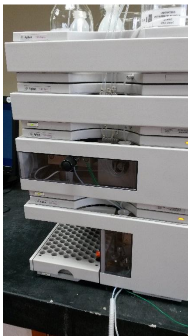
Figura 12. Cromatógrafo líquido Agilent 1100 Series- LC Systems and Modules - detector de índice de refracción -RID (California,USA)
