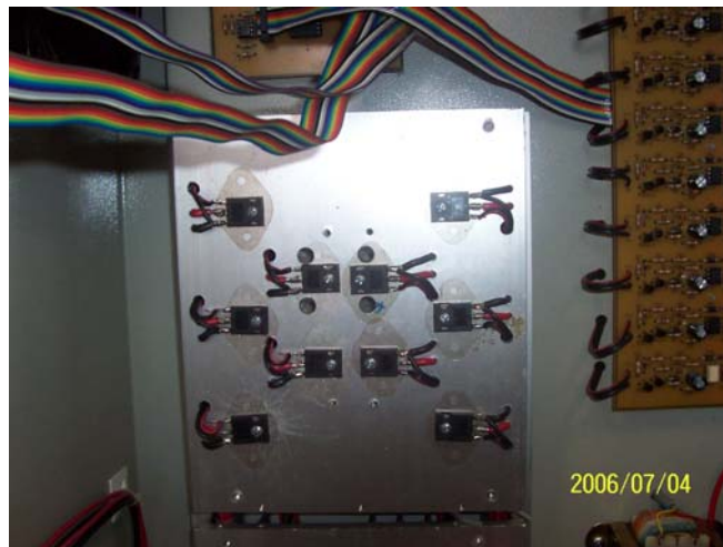
Figura 62 Distribución de los IGBT
