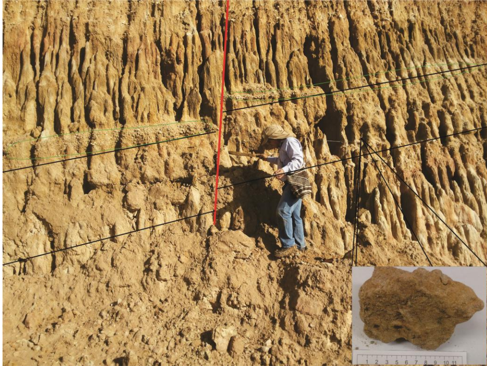
Figura 26. Capa 3 arenisca gravo-lodosas, paleosuelo parte superior de la capa, falla 1, muestra AM-01-05.
