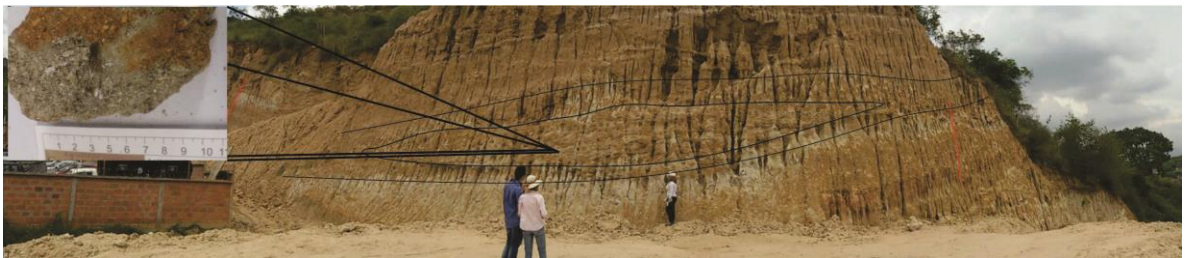
Figura 29. Capa 6 arenisca lodosa con algo de grava, lente en medio de la capa con la misma composición textural y mineralógica, muestra AM-01-13.
