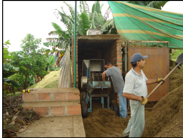
Figura 26. Máquina cortadora para homogenizar y reducir de tamaño los escombros
