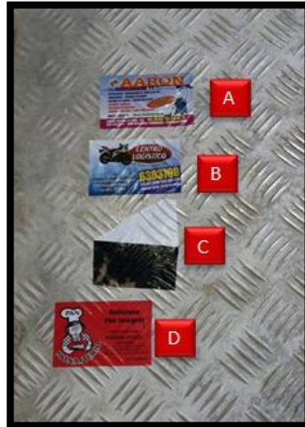
Figura 136. Prueba de adherencia a superficies rugosas.
