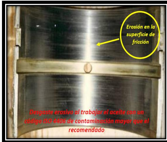
Figura 51. Desgaste erosivo.
