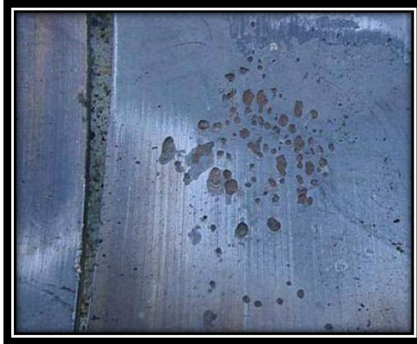
Figura 54. Desgaste por cavitación.
