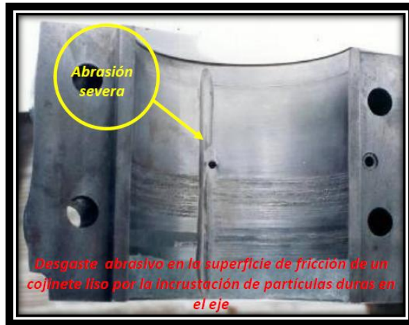
Figura 53. Desgaste abrasivo.
