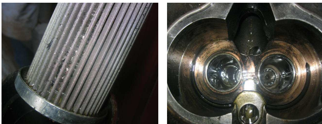
Figura 19. Limalla presente en filtros y bombas hidráulicas en los D11R.
