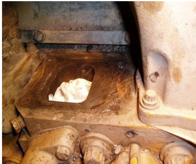
Figura 22. Foto de un motor en reparación por fuga de gases de escape
