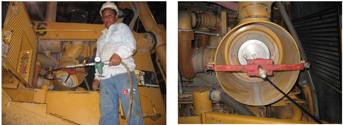
Figura 74. Prueba de Hermeticidad de los motores para los D11R
