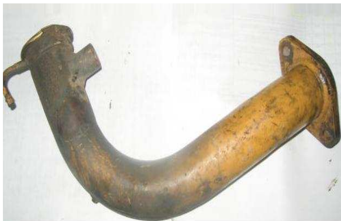
Figura 9. Tubo de llenado del sistema del Refrigerante en los D11R
