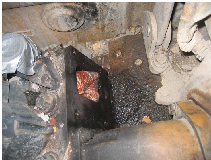
Figura 17. Fuga por el manifold de Escape del motor de los D11R
