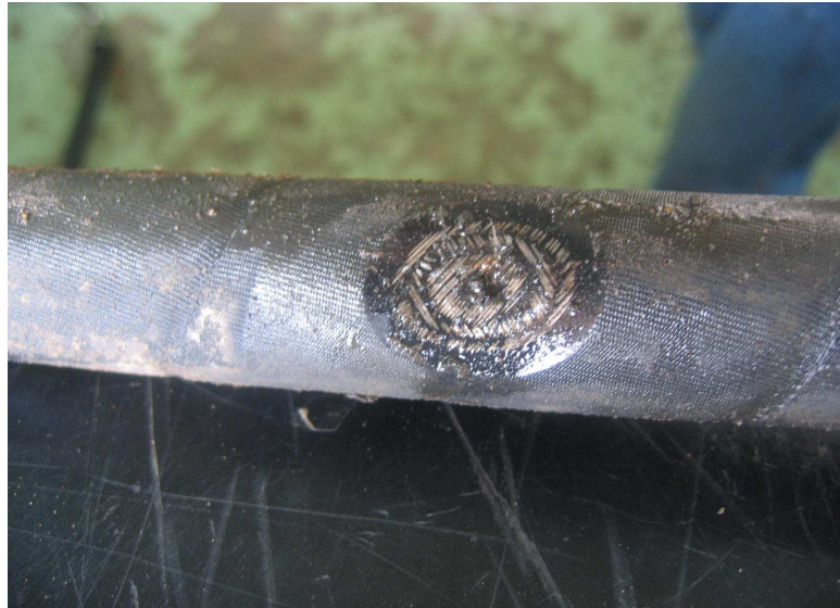
Figura 26. Manguera hidráulica D11R en mal estado
