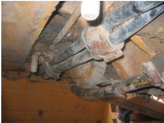
Figura 68. Una Manguera Bien Erutadas puede durar hasta 10.000 horas
