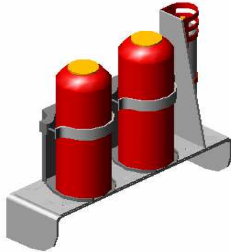
Figura 28. Base del sistema contra-incendio de los D11R
