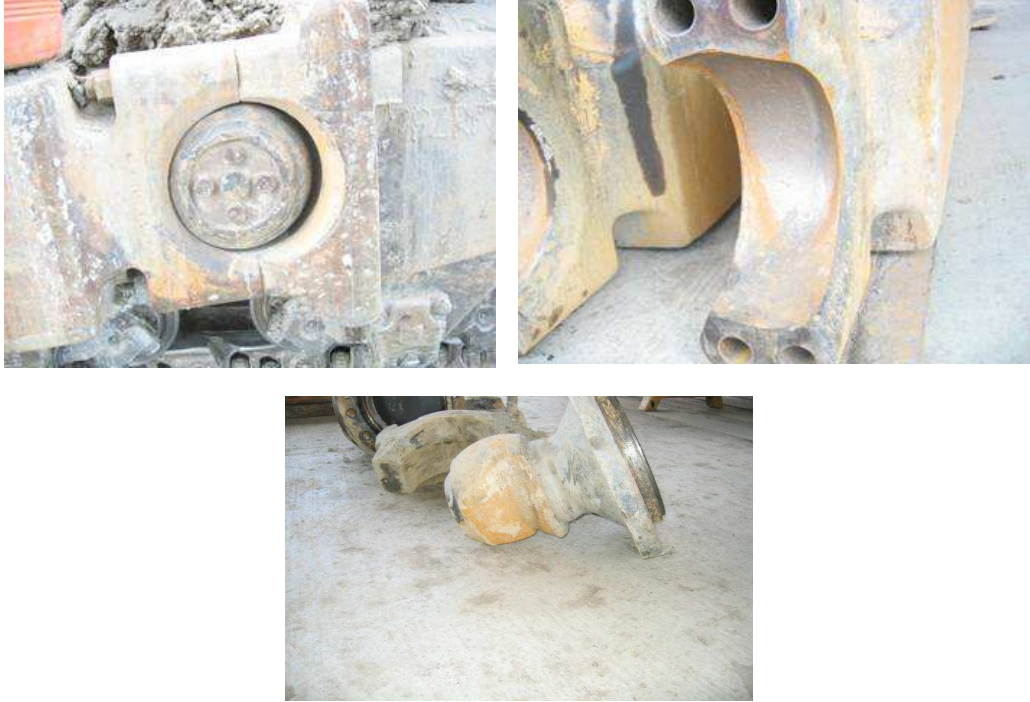
Figura 18. Desgaste presente en los brazos de empuje y el trunnion D11R.
