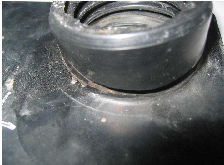
Figura 10. Sellos de polímeros para los Radiadores de los D11R
