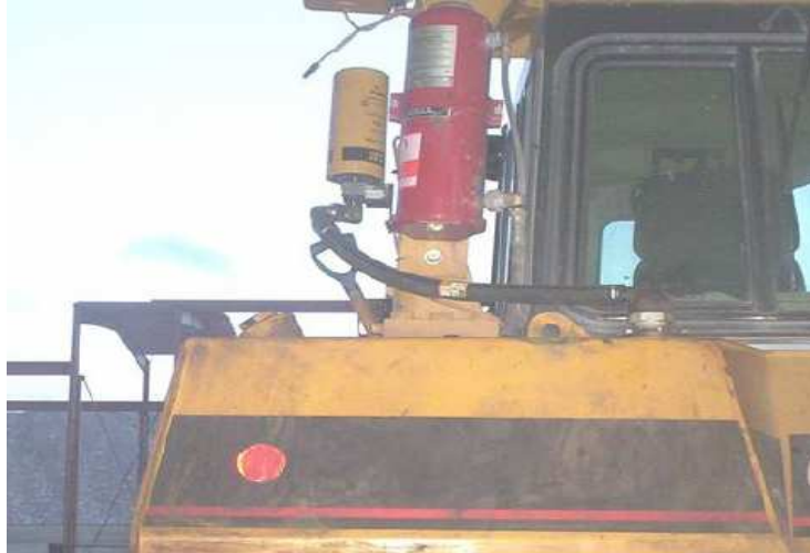
Figura 76. Respiradero del tanque del combustible.
