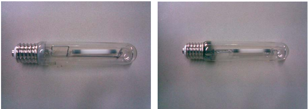
Figura 4. Bombillas que presentan avería por rotura o despresurización
