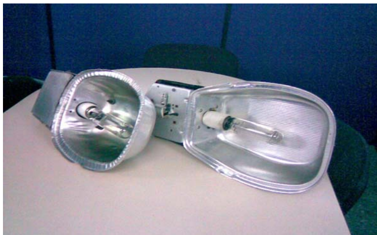
Figura 17. Luminarias de sodio de alta presión para reposición
