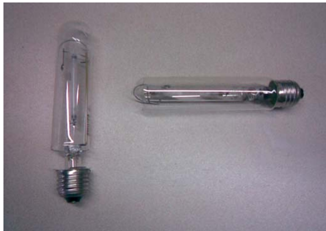
Figura 11. Bombillas con el bulbo exterior, fisurado o agrietado
