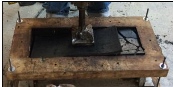
Figura 19. Proceso de compactación
