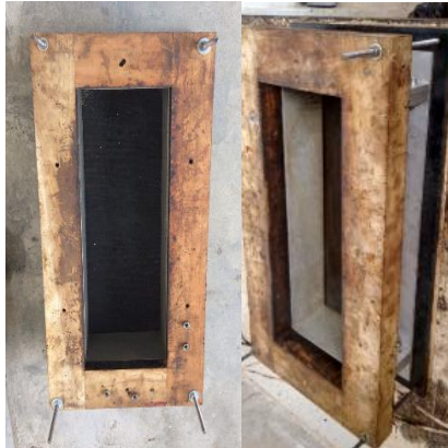
Figura 16. Molde para compactación.
