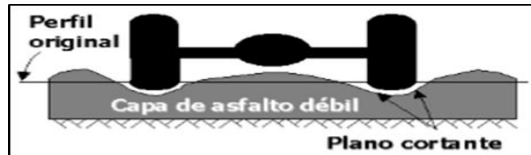
Figura 3- Falla por mezcla asfáltica
