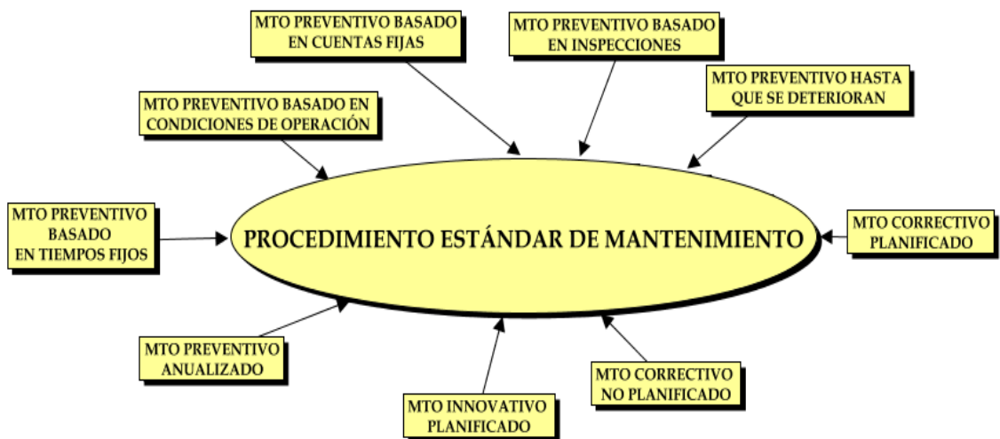
Figura 21. Procedimientos estándar de mantenimiento
