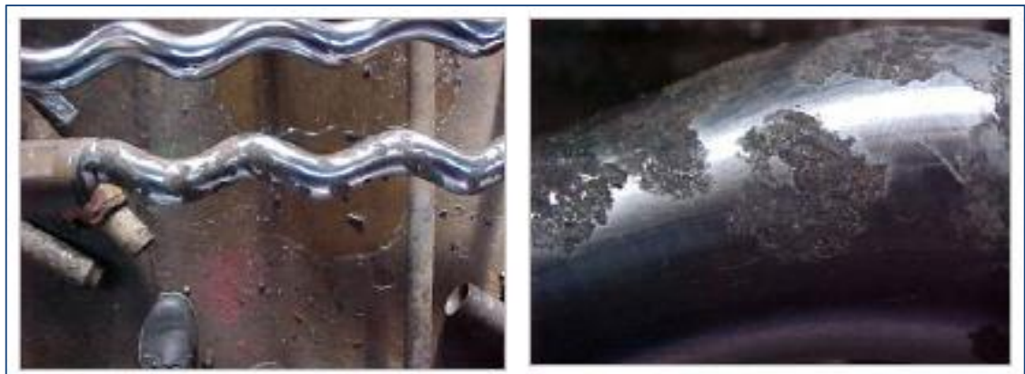
Figura 18. Cromado saltado sin afectar el material base.
