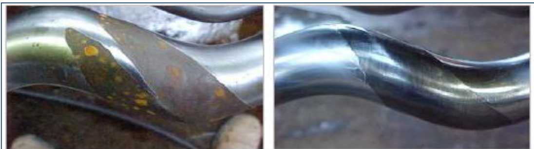
Figura 17. Desgaste por abrasión sin afectar material base.
