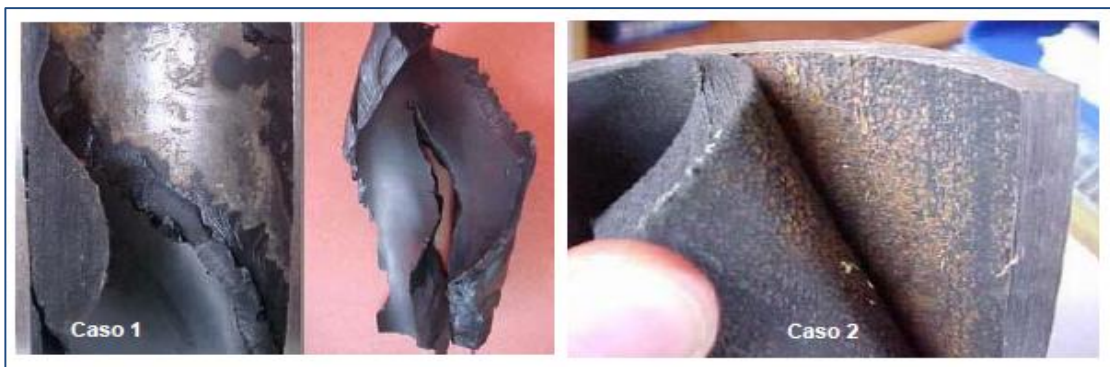
Figura 15. Fallas por Elastómeros Despegados.
