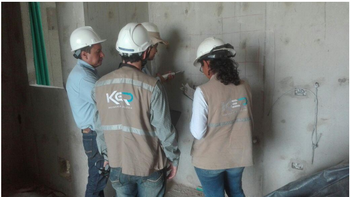
Foto 7. Acompañamiento al ensayo de Esclerometría.
