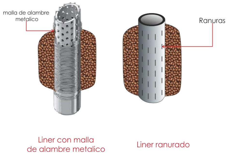
FIGURA 14. Métodos básicos de control de arenas
