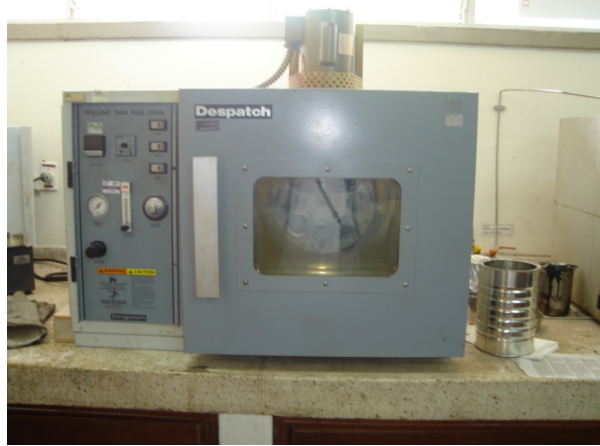
Fotografía 1. Horno de película delgada rotativa (RTFO).
