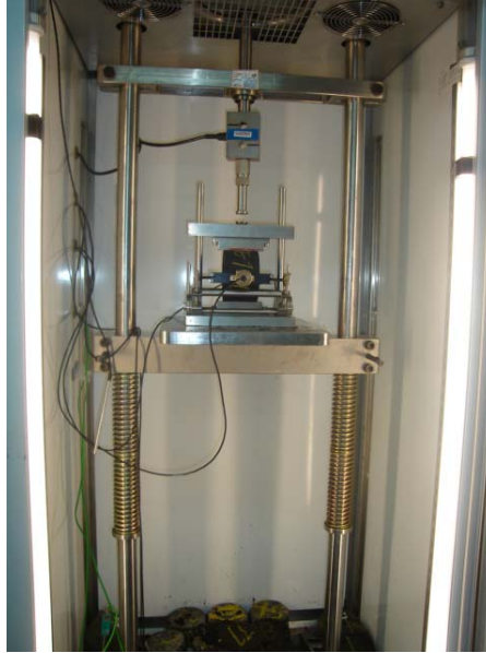
Fotografía 7. Equipo NAT Servohidráulico.
