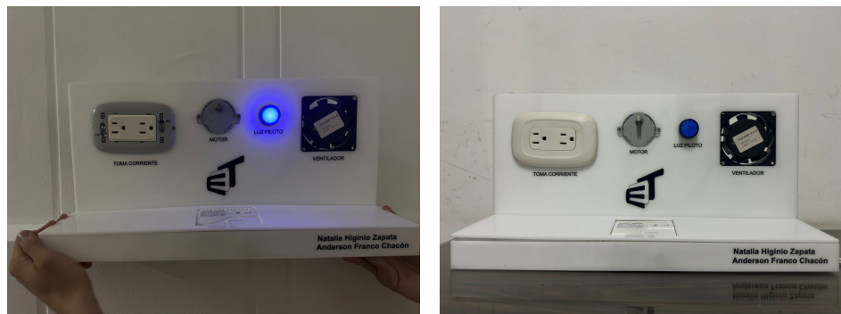
(a) Activación de la luz piloto
