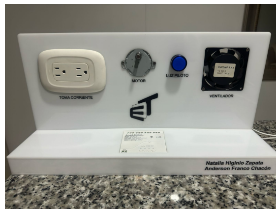
Figura 4. Montaje conexiones del switch con las cargas.
