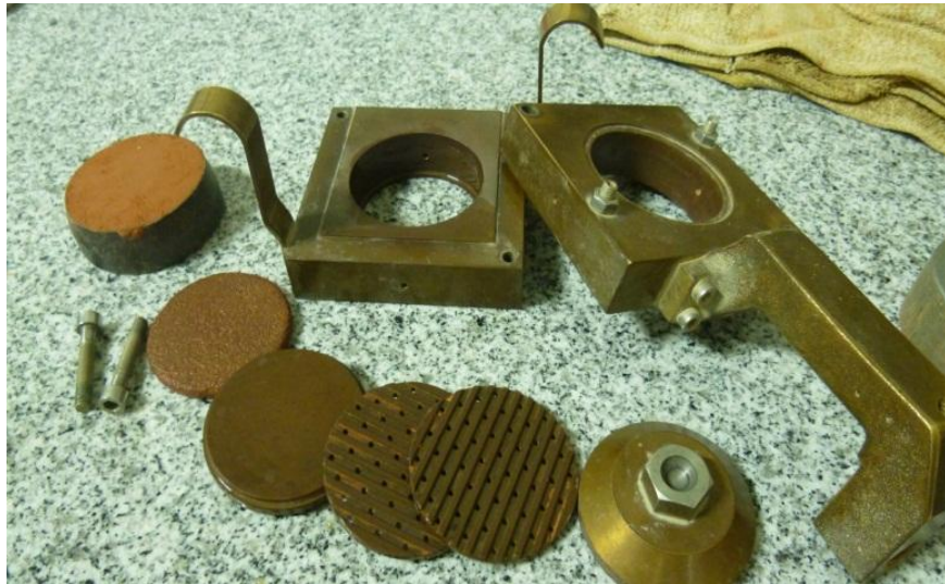
Figura 6. Partes de la caja de corte
