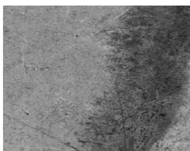
Figura 3 . Micrografías SEM y espectro de emisión de rayos x de acero cold rolled con proceso de limpieza haciendo uso de producto comercial
