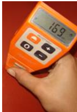
Figura 1. Medida de espesores de película seca
