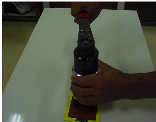
Figura 3. Medida de la Adherencia del Recubrimiento
