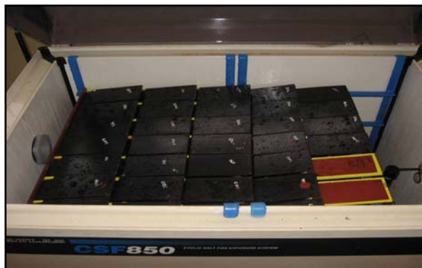
Figura 2. Cámara a humedad relativa del 100% de los cupones para evaluación de compatibilidad imprimante
