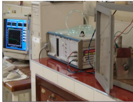
Figura 4. Medida de resistencia de poro por espectroscopia de impedancia electroquímica
