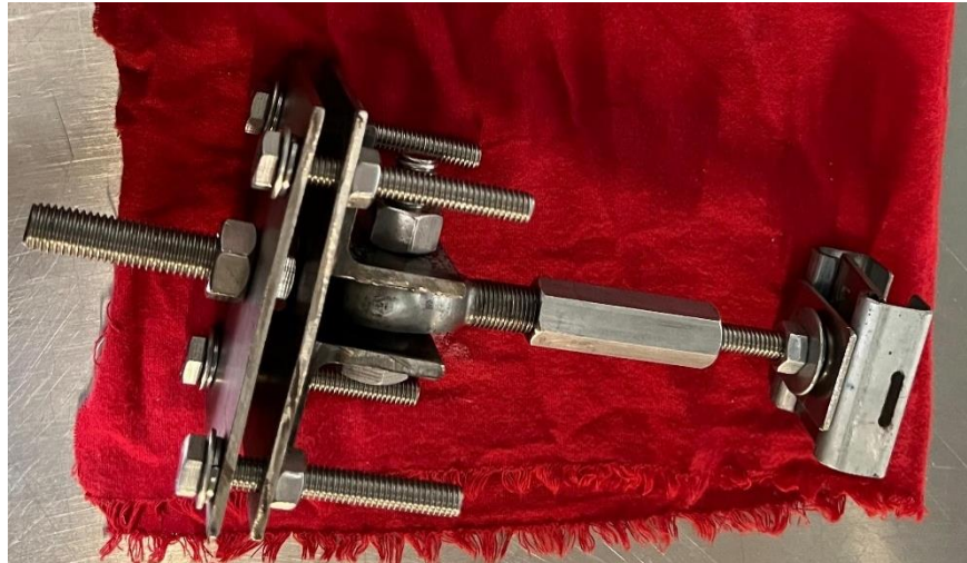
Figura 11 Mecanismo acoplador para alineación de probetas
