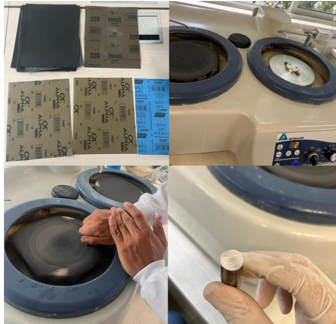
Figura 8 Proceso de refrentado de las probetas
