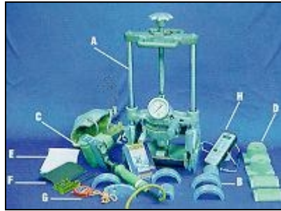
Foto 15. Equipo Utilizado en el Procedimiento de Unión de Silletas por Termofusión.
