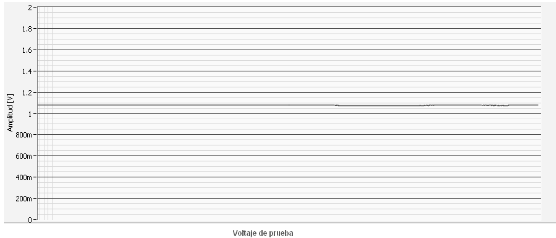
Figura 84. Gráfica de adquisición por Labview de un voltaje constante de 1.1 V
