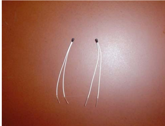
Figura 10. Termistores de referencia KS103J4
