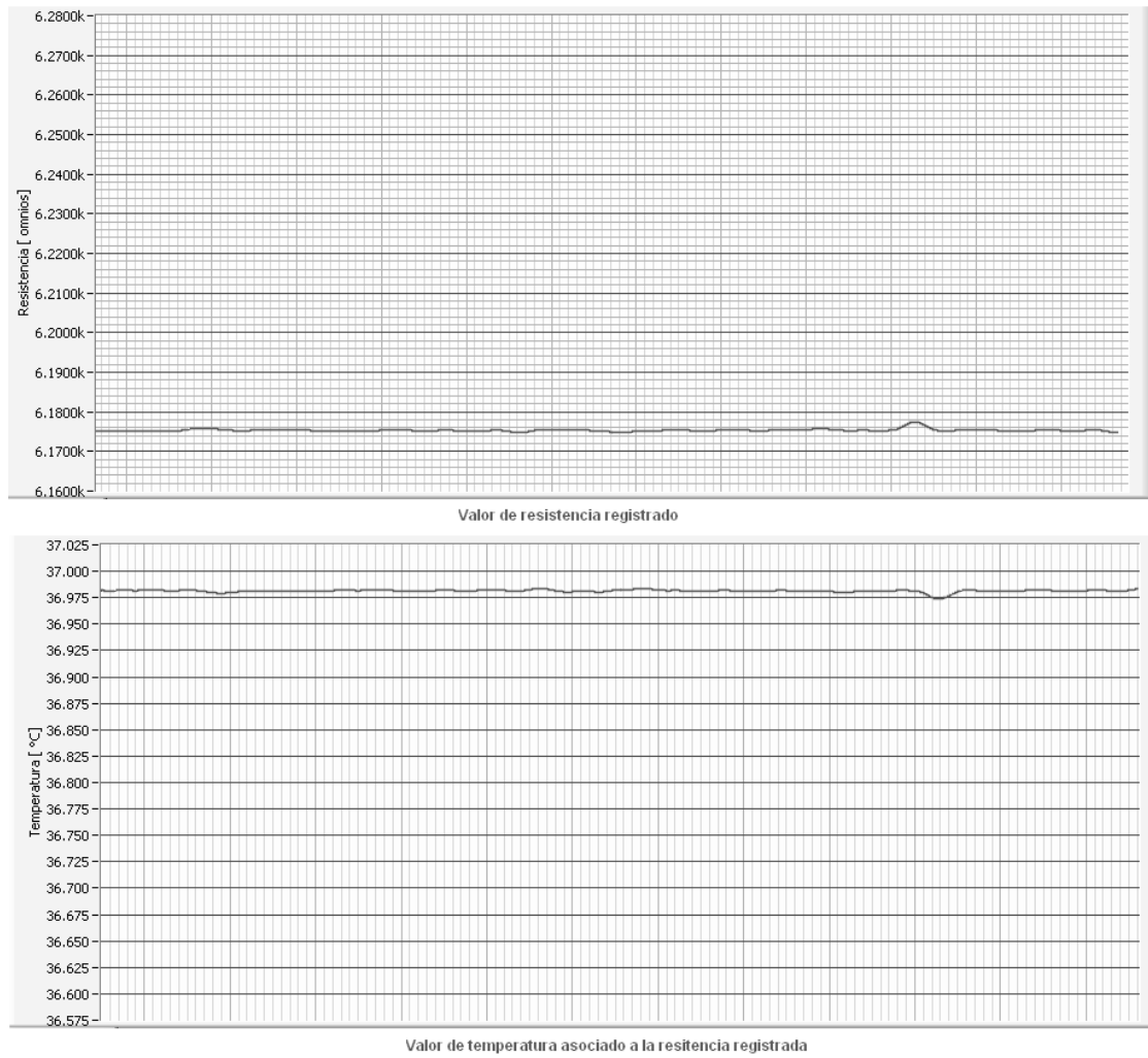
Figura 83. Gráfica de la resistencia conectada a la entrada del canal de temperatura y temperatura asociada a dicho valor
