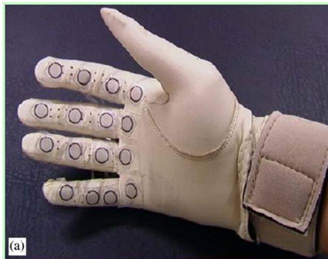
Figura 3. Sensores de fuerza A101-25 instalados en un guante
