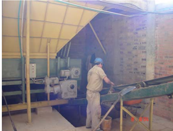
Figura 29. Eliminación de piedra manual.
