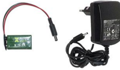
Figura 127. Transformador y batería con conectores machos de 2.1 mm, alimentación externa del Arduino. Fuente: www.tucamon.es/contenido/tus-proyectos-6
