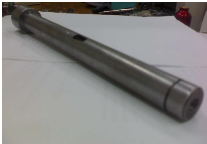
Figura 114. Eje con acople rígido, Representación hecha en SolidWorks y fotografía.
