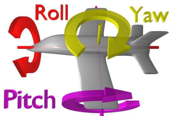
Figura 34. Ángulos de inclinación que permite leer un IMU.
