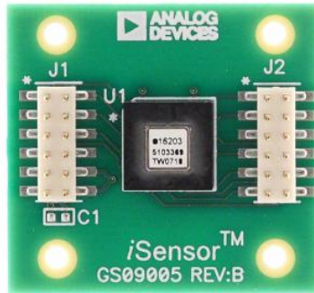
Figura 49. Inclinómetro ADIS 16203 montado en PCB.
