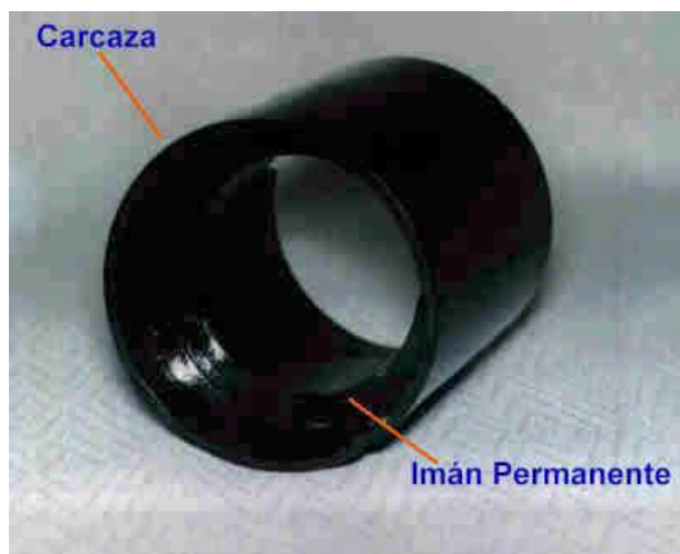
Figuras 12. Estator. Fuente www.todorobot.com.ar
