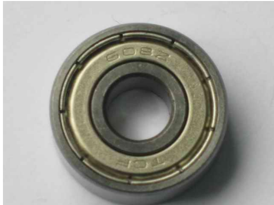
Figura 102. Rodamientos usados en los rodillos.
