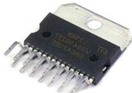
Figura 60. Integrado L298N, representación en diagrama de bloques y fotografía.
