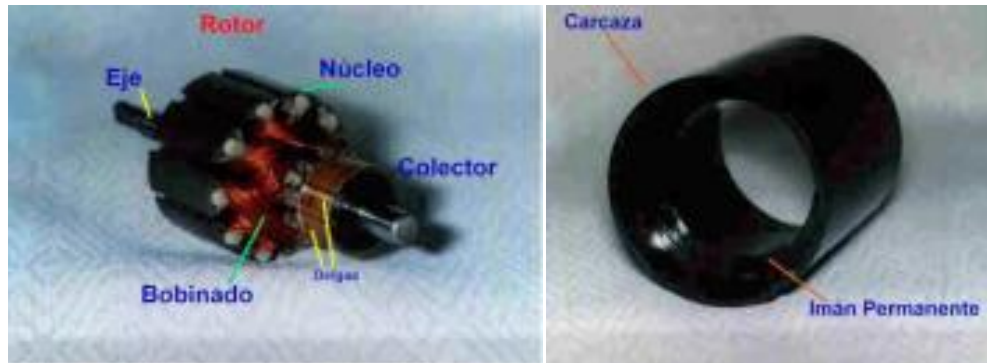
Figura 9. Rotor y estator. Fuente: www.todorobot.com.ar
