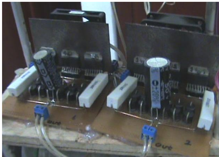
Figura 61. Arreglo de integrados L298N en paralelo.
