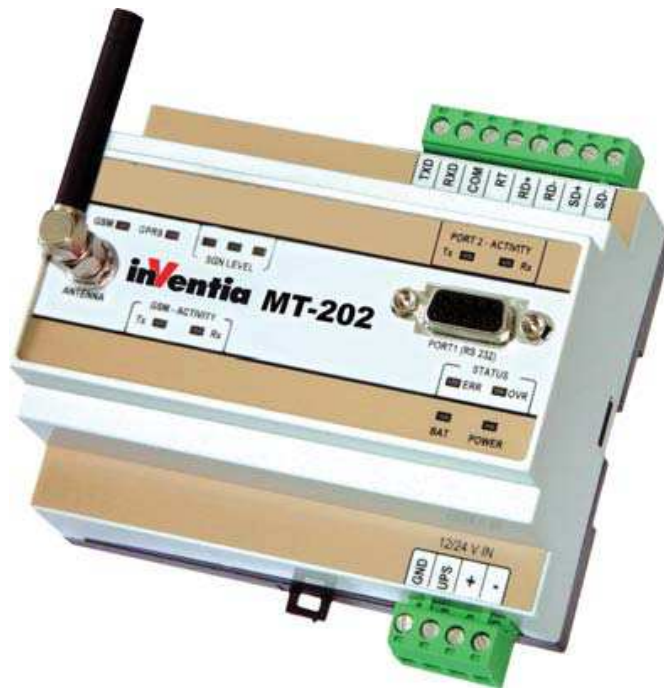
Figura 20 – Unidad de recepción de datos e intercambio con servidor Fuente: Ficha técnica Inventia MT102 - inventia@inventia.pl, www.inventia.pl
