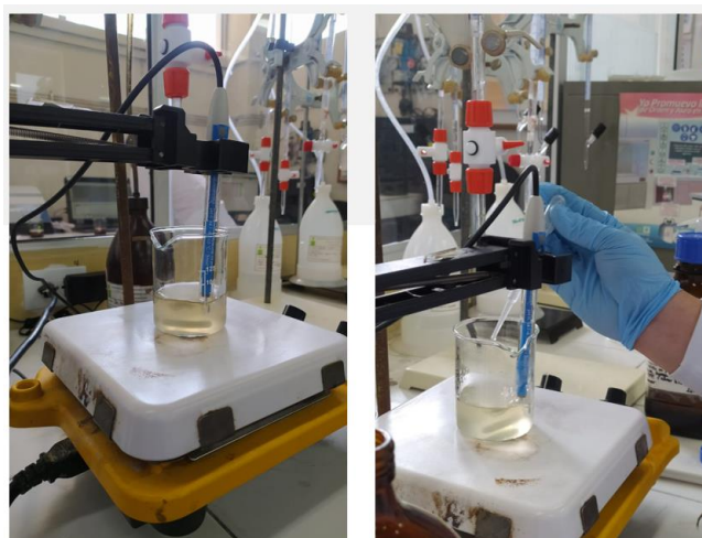
Figura 7. Determinación y ajuste de pH en las muestras.
