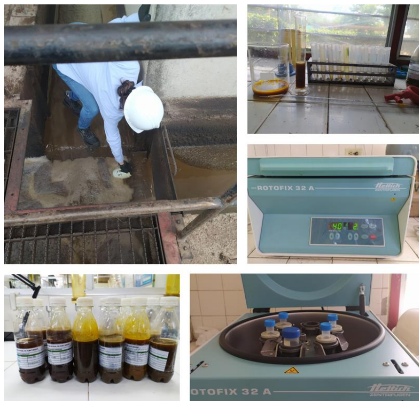
Figura 5. Proceso de toma y preparación de las muestras de agua del proceso de extracción de aceite de palma.
