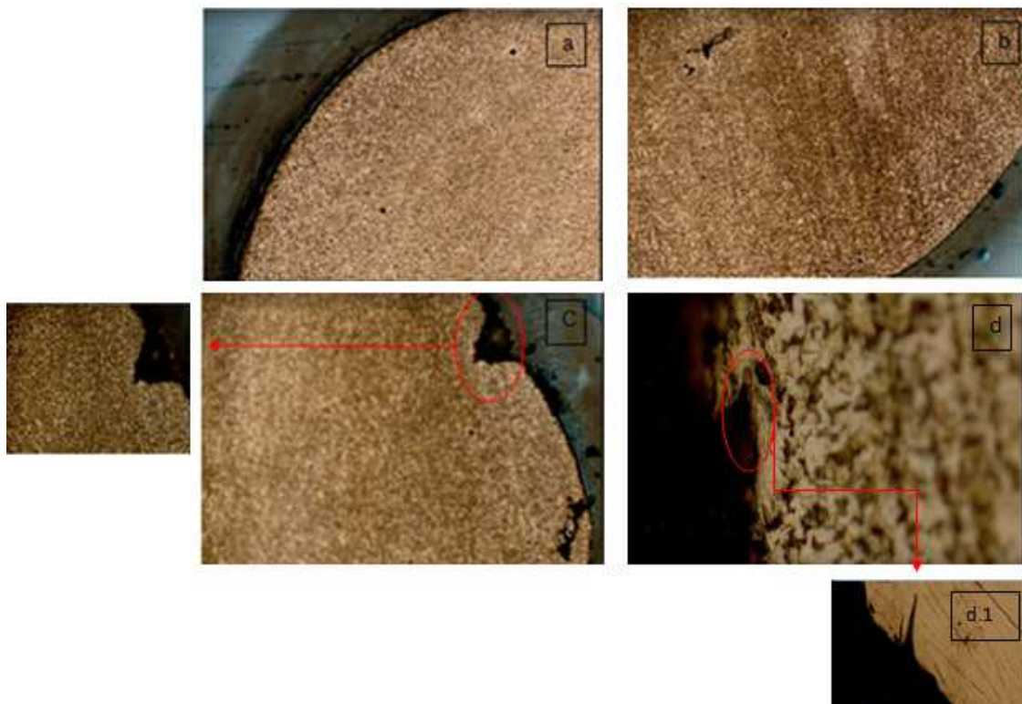
Figura 16. Micrografías obtenidas mediante el microscopio óptico para cada una de las soluciones en la superficie de fractura (a) Probeta en blanco, (b) Probeta 1% de agua, (c) Probeta 4% de agua, (d) Probeta 5% de agua.
