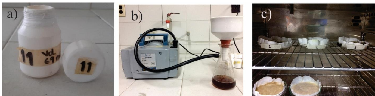
Figura 16. Equipo usado para los tratamientos alcalinos hidrotérmicos. a) Reactor de teflón. b) Montaje para la filtración del fluido alcalino. c) Resultado del filtrado en el interior del horno que completaría la desecación de las muestras.
