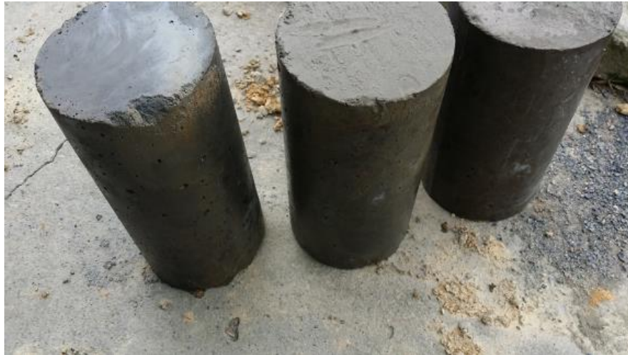
Figura 13. Muestras de concreto tomadas
