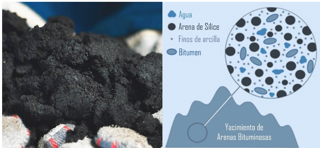
Figura 4. Composición de las Arenas Bituminosas.
