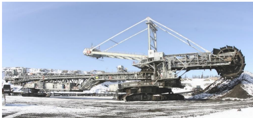
Figura 39. Excavadora de Rueda de Cangilones.
