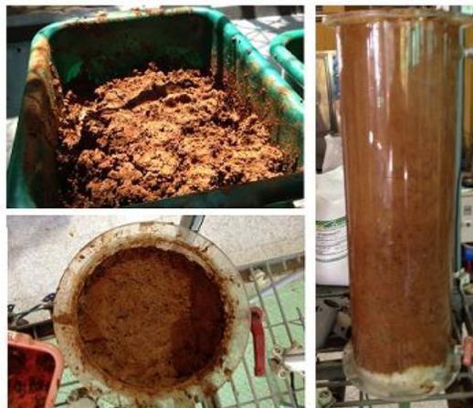
a segunda estrategia de llenado de las columnas del mesocosmos incluyó la homogenización mecánica previa, del suelo muestreado en el ASA. Para el procedimiento de homogenización mecánica y reducción del tamaño de partícula del suelo se empleó un tornillo sinfín con una capacidad de carga de 400 Kg el cual fue cargado y operado durante 20 min para obtener un suelo homogéneo (Figura 18).
