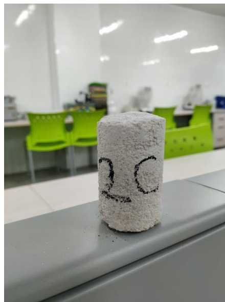
Figura 19. Plug Consolidado 2c Arena/Endurecedor/ARPP.
