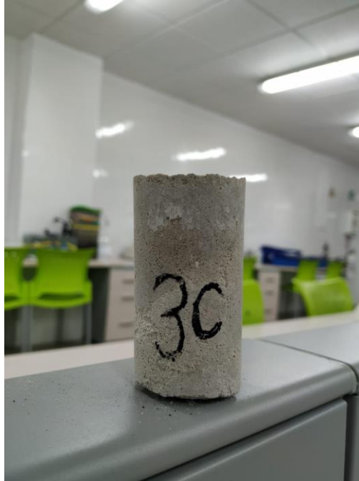
Figura 20. Plug Consolidado 3c Arena/Endurecedor/ARPP.
