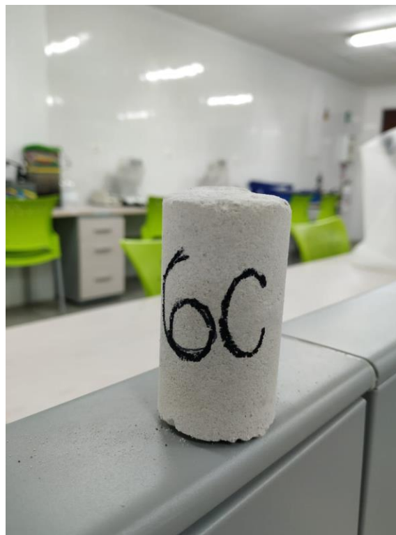
Figura 23. Plug Consolidado 6c Arena/Endurecedor/ARPP.
