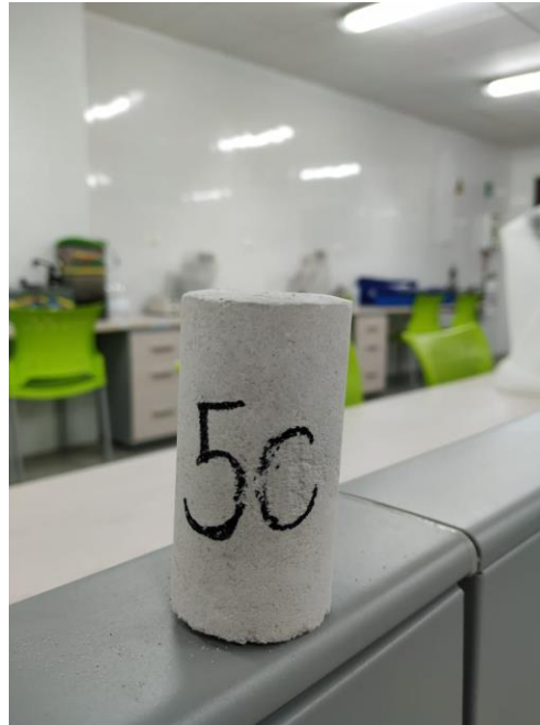
Figura 22. Plug Consolidado 5c Arena/Endurecedor/ARPP.
