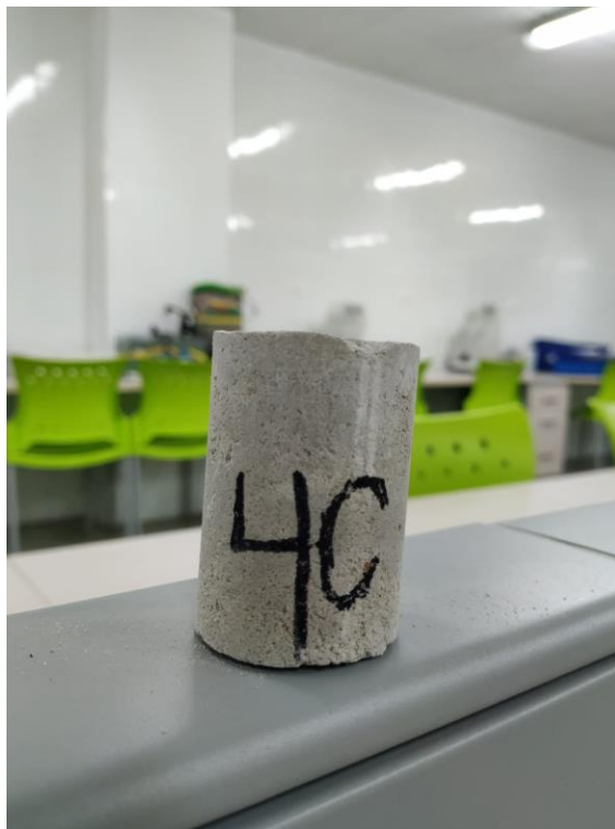
Figura 21. Plug Consolidado 4c Arena/Endurecedor/ARPP.
