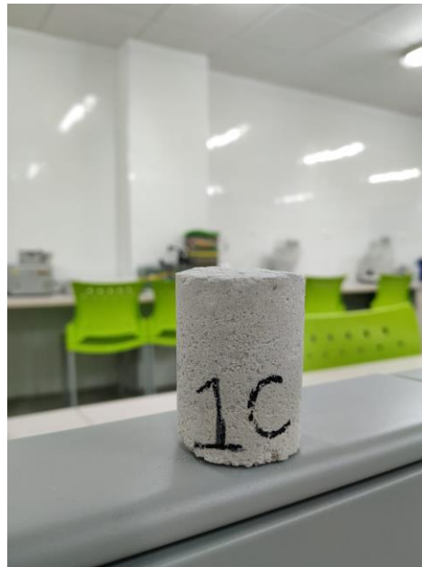
Figura 18. Plug Consolidado 1c Arena/Endurecedor/ARPP.
