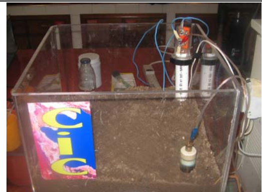
Fotografía 7. Montaje del electrodo Cu/CuSO 4 cerca a la estructura
