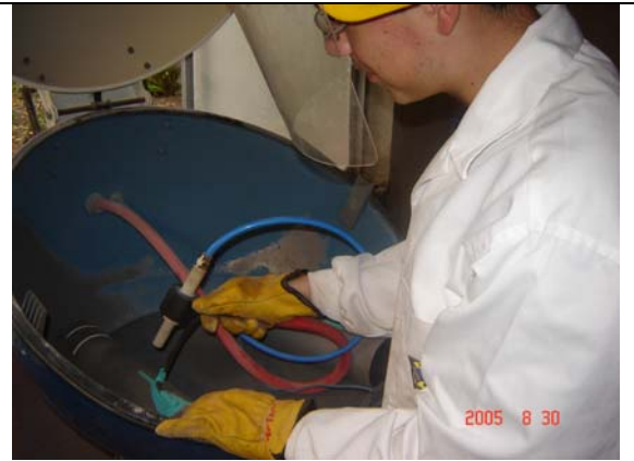
Fotografía 5. Limpieza abrasiva de la superficie metálica de los tubos mediante Micro-sandblasting
