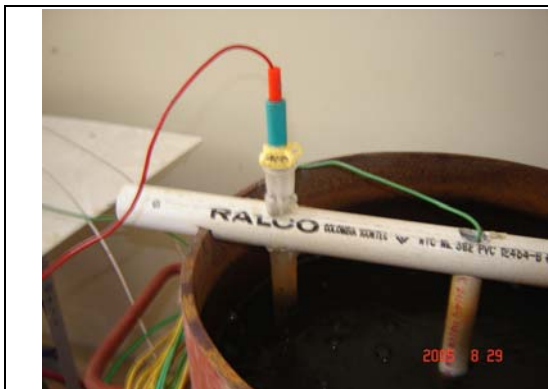
Fotografía 6. Montaje de lugins cercano a la pared de los tanques
