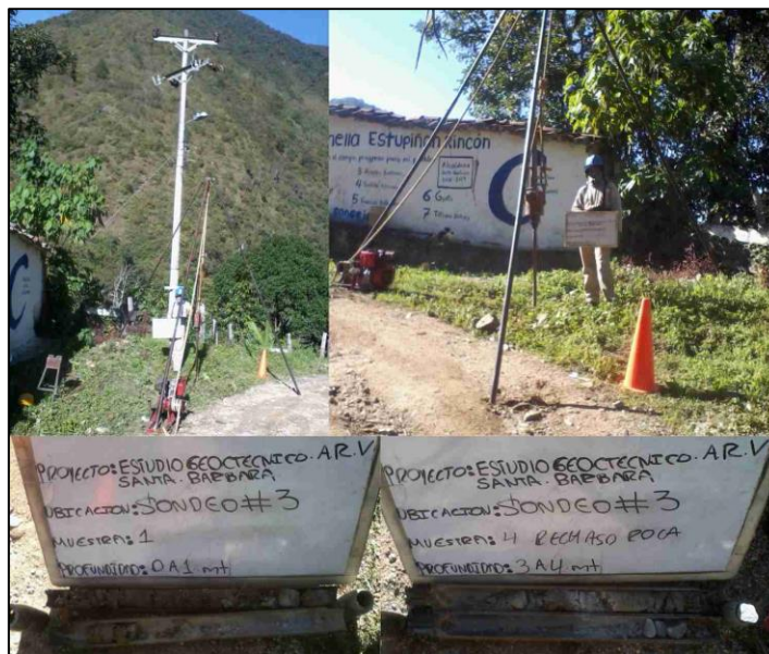
Figura 81. Registro fotográfico sondeo 3 de percusión.
