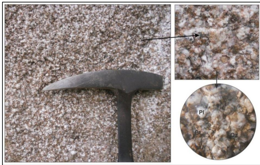
Figura 26. Imagen a detalle de la cuarzomonzonita clara rica en plagioclasa, biotítica y de grano grueso.
