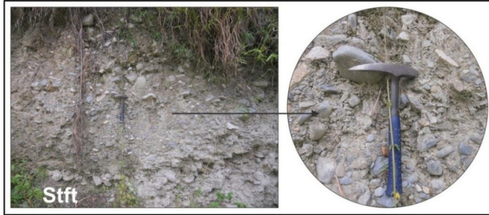
Figura 35. Suelos transportados fluvio-torrenciales vistos al margen Oeste de la Quebrada Esparta. Nota. Se identificaron depósitos fluvio-torrenciales a extremo Oeste del Río Umpalá (Coordenadas N: 1264917 m; E: 1129097 m; Z: 1894 msnm).
