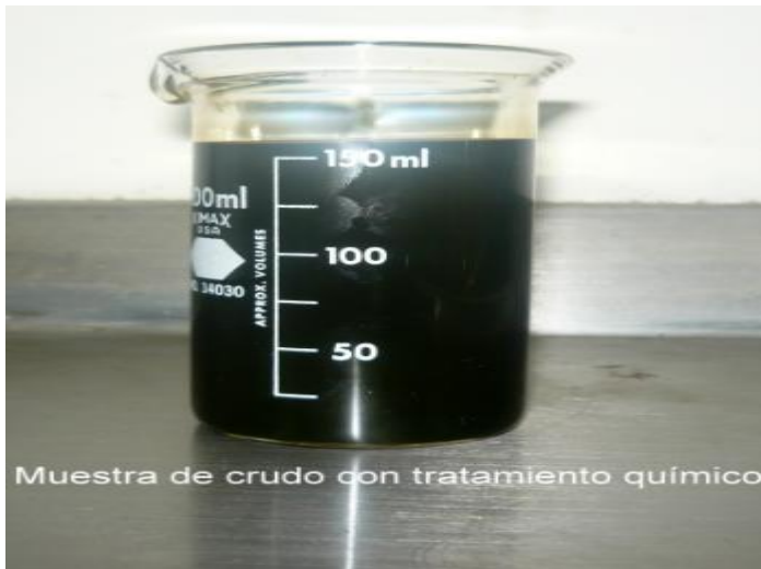
Figura 10. Compatibilidad visual del crudo con tratamiento químico.
