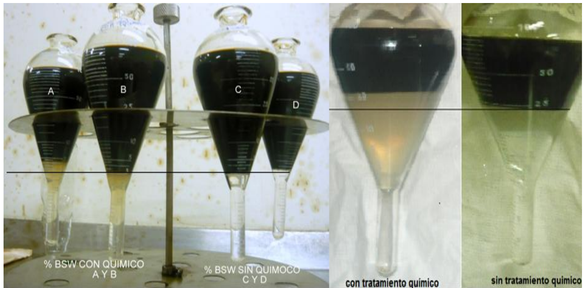
Figura 13. Prueba de la botella para determinar el Bsw.
