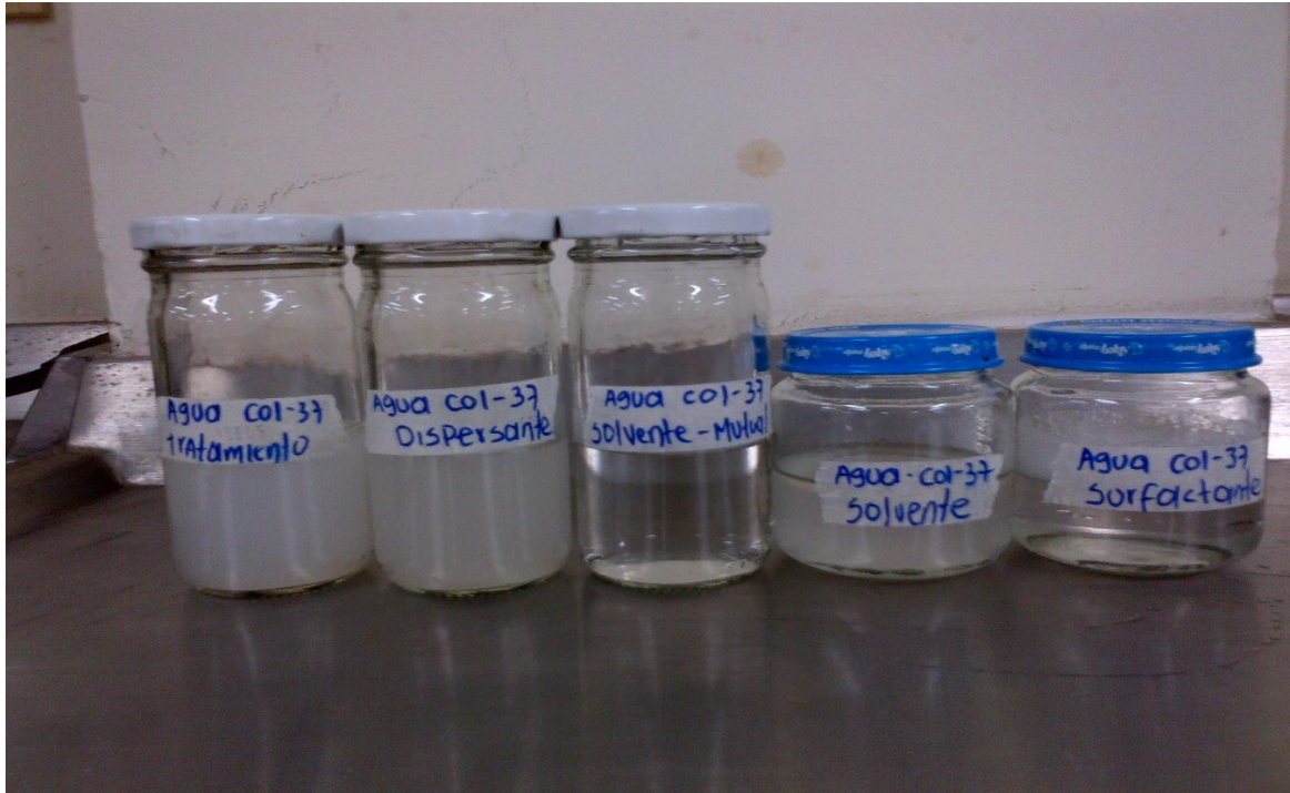
Figura 11. Compatibilidad visual para el agua de formación.
