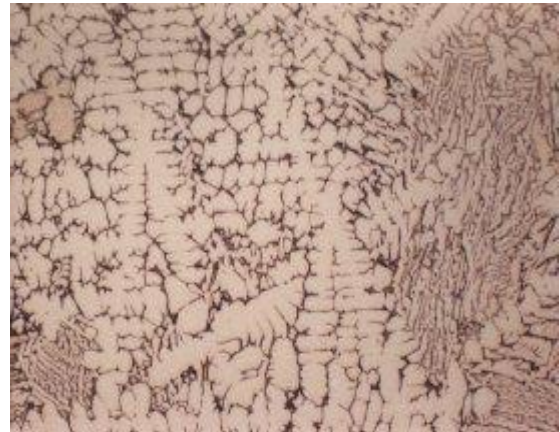
(b) Microestructura del latón 65/35, colado en coquilla. Ataque con dicromato, X100. Fuente: FERRER G., Carlos. Curso de Ciencia de los materiales. UPV (11)
