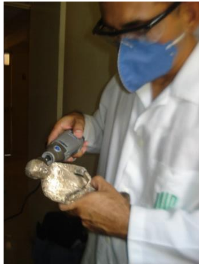
Figura 15. Procedimiento de corte, cincelado y limpieza
