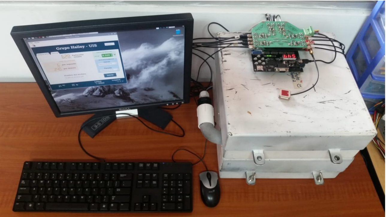
Figura 42: Ensamble del detector completo, los paneles centelladores se observan cerrados en sus cajas metálicas, la electrónica de discriminación funcional y la interfaz en la pantalla conectada a la Raspberry Pi
