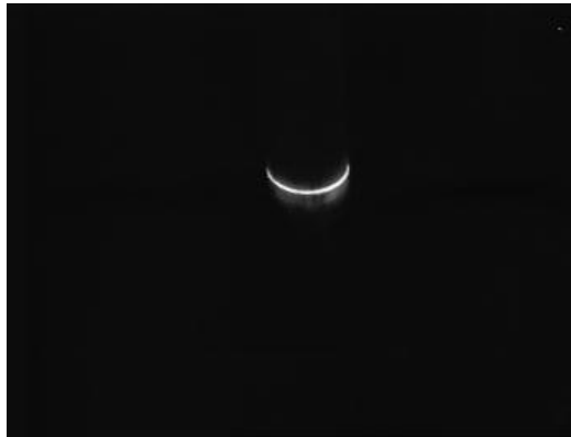
Figura 29. Imagen de un objeto con contorno circular con la única iluminación de la línea láser.
