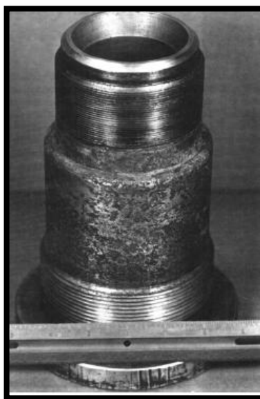
Figura 77. Disco y boquilla con deformaciones por corrosión
