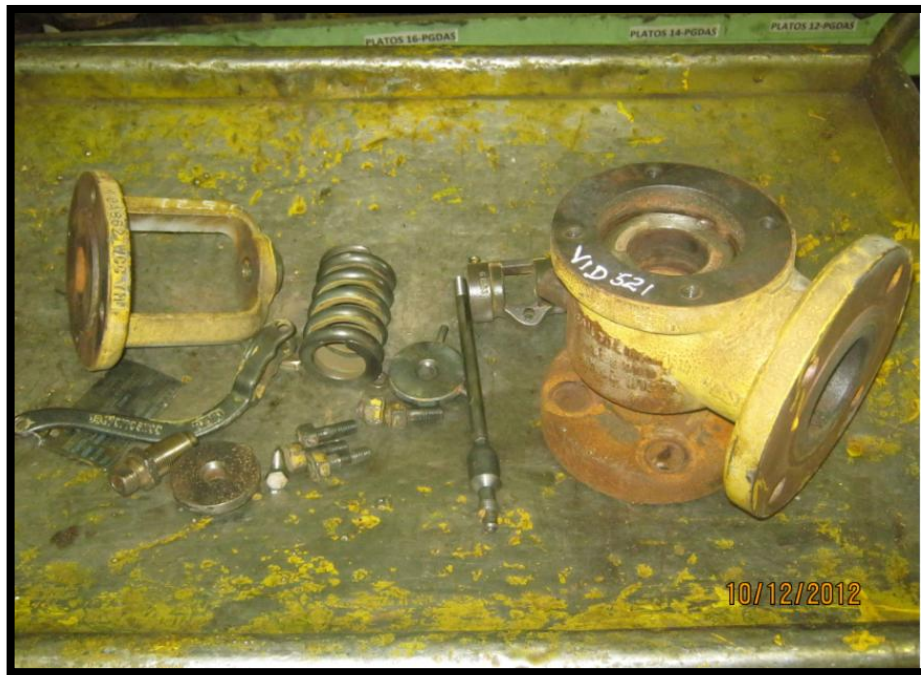
Figura 75. Desarme válvula de alivio de presión.
