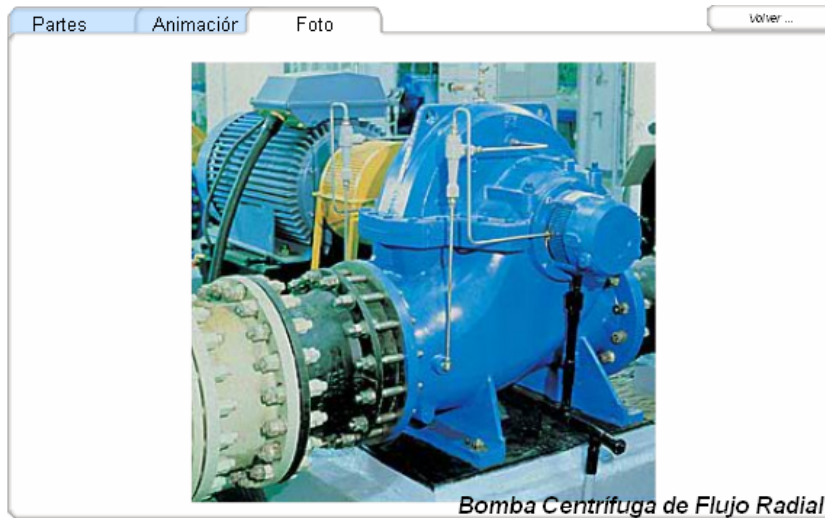
Figura 9. Imagen real de una bomba centrífuga de flujo radial.
