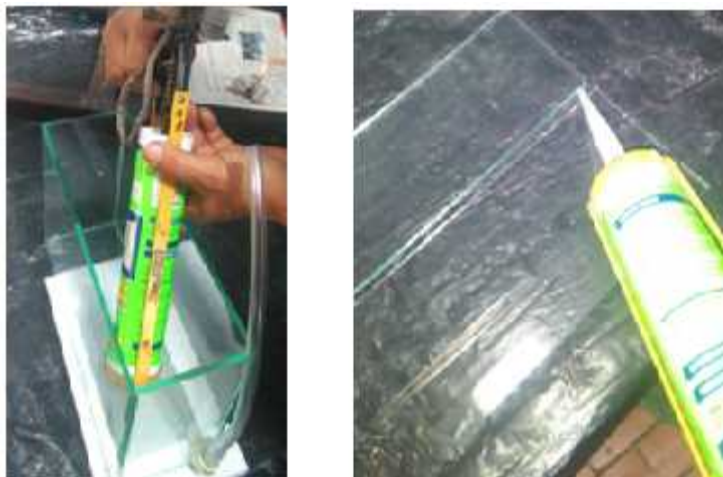
Figura 20. Proceso de adherencia
