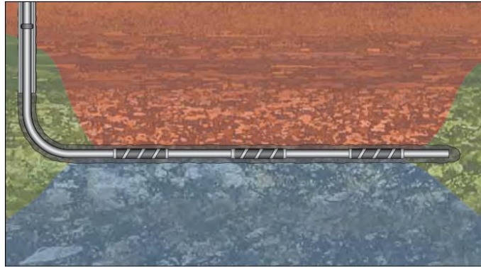
Figura 28. Efecto Talón-Punta con arreglo de ICD
