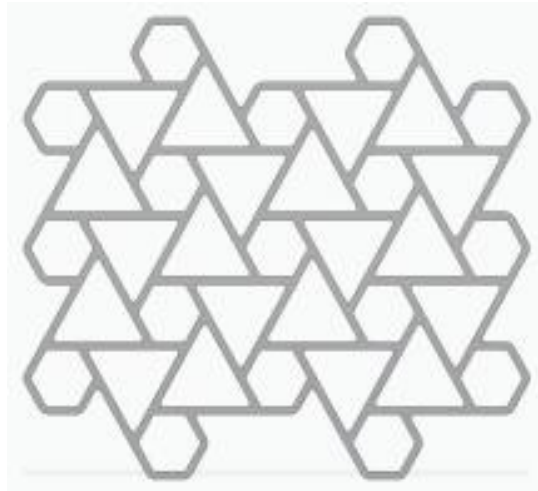
Figura 4. Panal quiral. Tomado de Diseño, construcción y caracterización de un material auxético. Sierra (2017).
