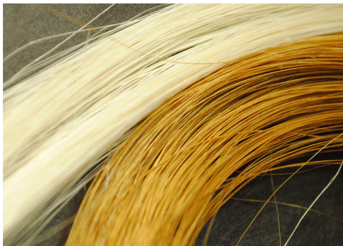
Figura 6. Comparación de la coloración de las fibras limpias (blanco) y las fibras modificadas con nanopartículas de plata (dorado).
