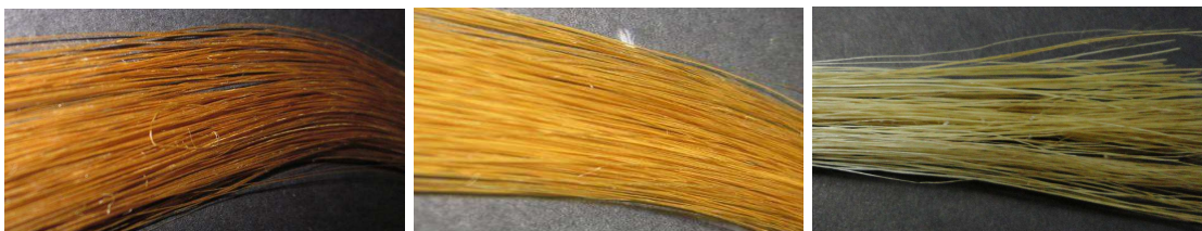
Figura 9. Fibras de fique modificadas con nanopartículas de plata variando el solvente de preparación de la solución metálica. De izquierda a derecha: en agua, agua:glicerol 1:1 y glicerol.
