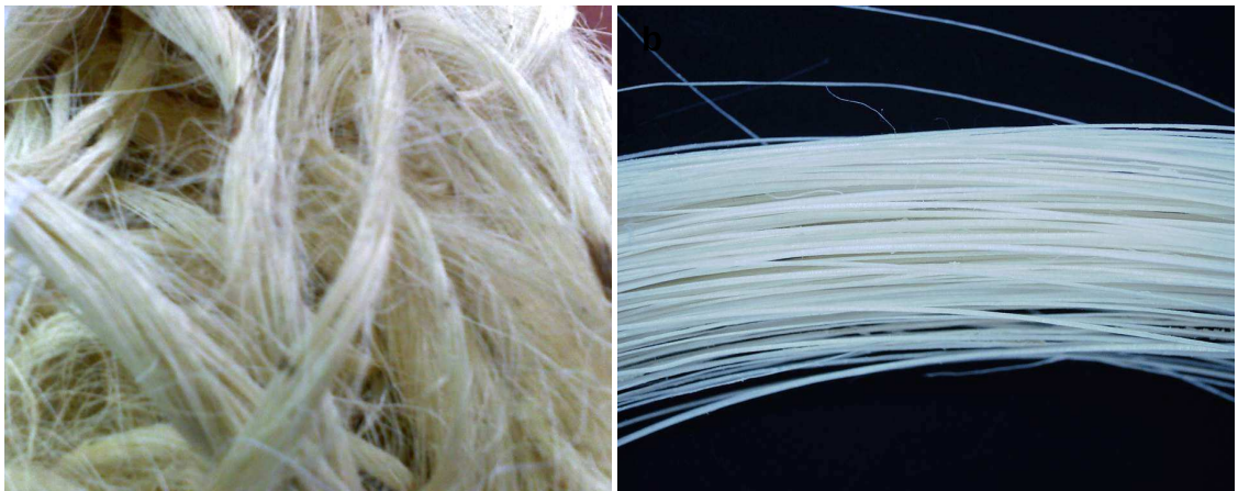
Figura 5. Fibras de fique. De izquierda a derecha: sin tratamiento y luego de la limpieza y cepillado.
