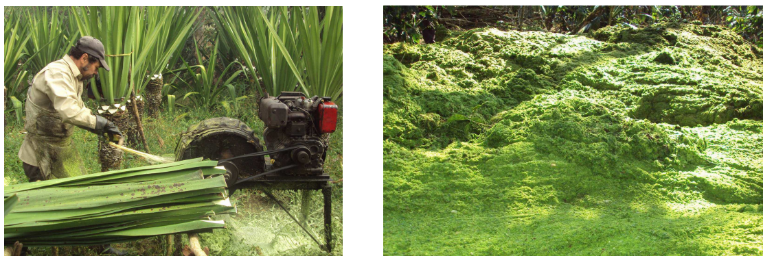
Figura 1. Desfibrado de la hoja de fique. De izquierda a derecha: campesino realizando el proceso y residuos acumulados.
