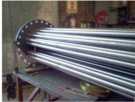
Figura 141. Haz de tubos para intercambiadores de calor.
