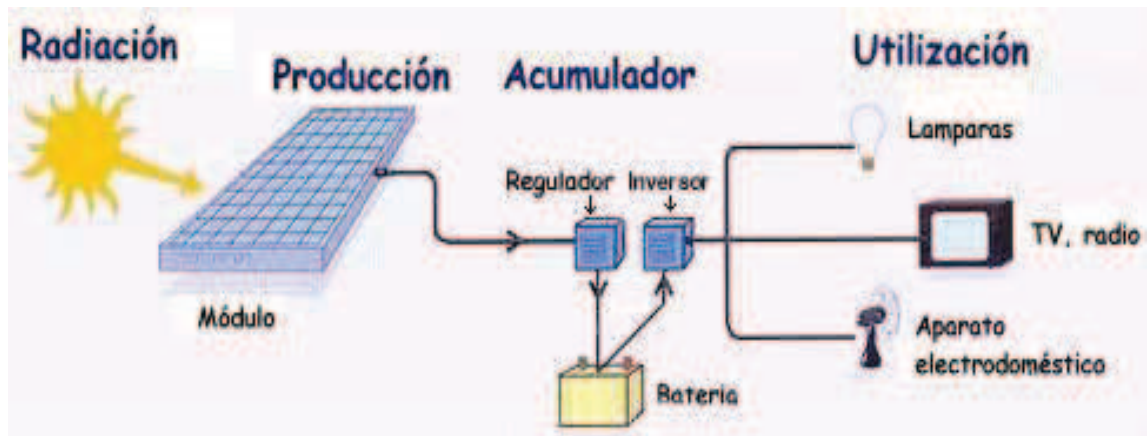
Figura 4. Esquema de sistema fotovoltaico.
