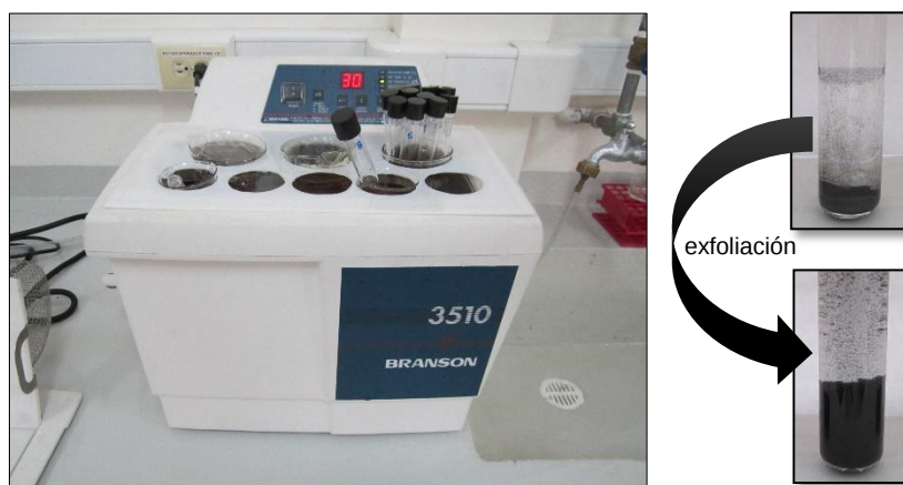
Figura 26. Exfoliación de cristales de grafito con ultrasonido.
